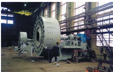
Рисунок 2. Мельница самоизмельчения консольного типа с размерами барабана D \times L = 4,0 \times 1,4 м
