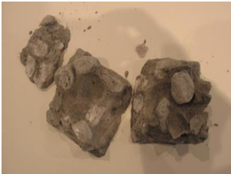
Рис.7. Испытание образца, подготовленного в планетарной мельнице на одноосное сжатие
