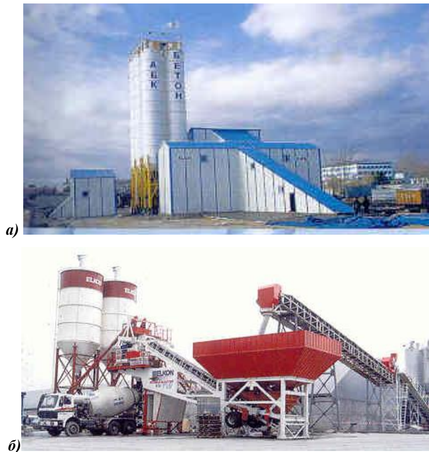
Рис.5 а,б. Варианты бетонных заводов
