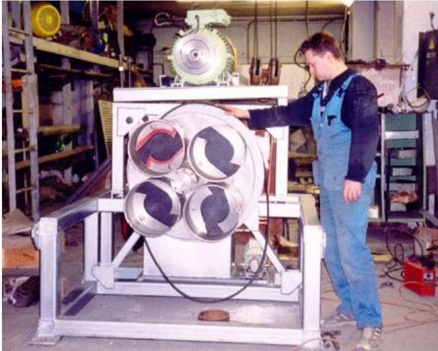
Рис.6. Планетарная мельница МП-1 непрерывного действия (мощность- 50кВт)
