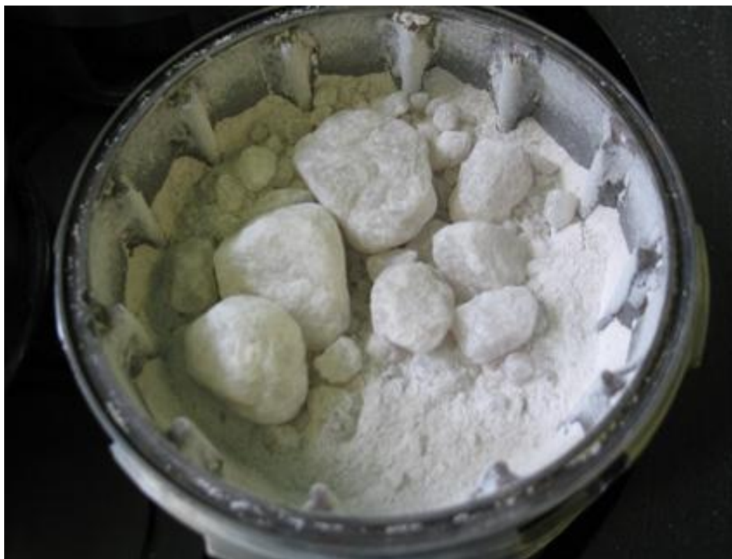
Рис.4. Готовая сухая бетонная смесь в барабане планетарной мельницы
