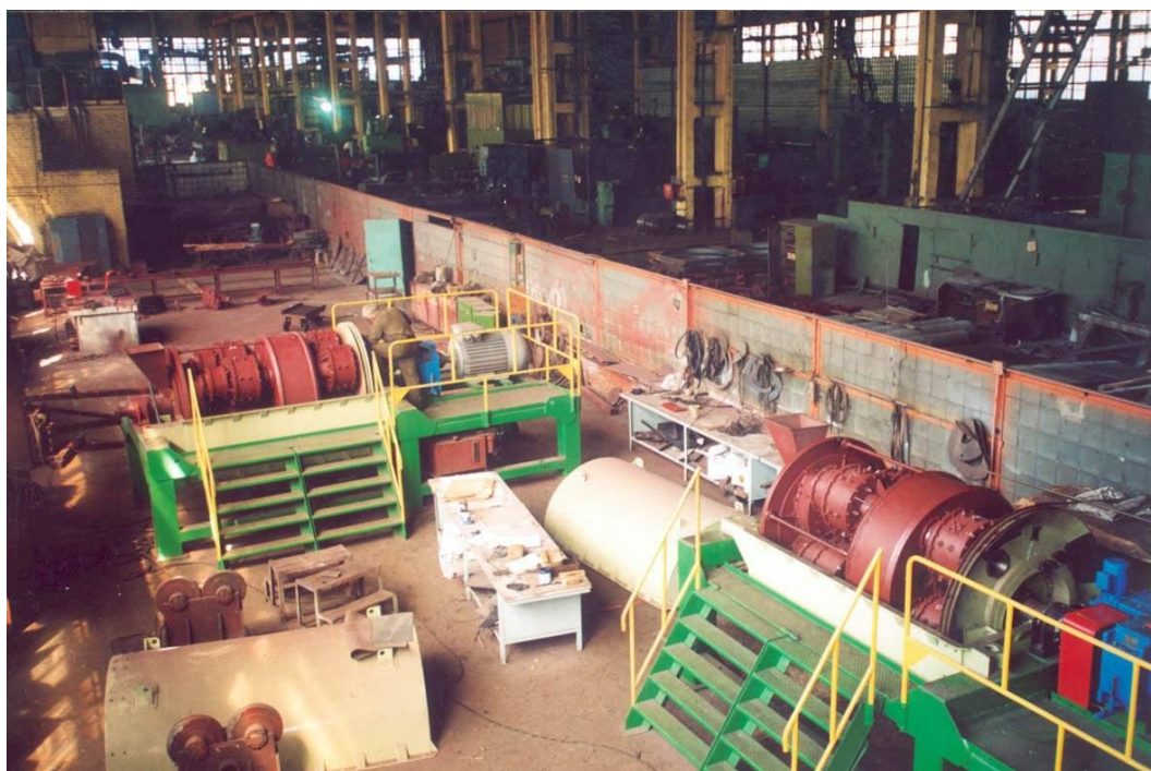
Рис.3. Планетарная мельница МП-4 непрерывного действия (мощность- 200кВт)
