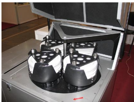
Рисунок 11- Планетарная мельница периодического действия МПП-2-1 К
